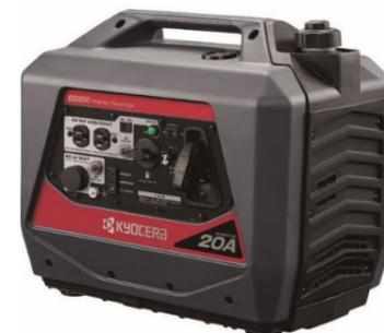
負荷に応じてエンジン回転数を制御する省エネモードがあります。高品質な電気を安定供給する正弦波インバーター搭載です。コンセント形状：単相100V用×2、DC12Vシガーソケット×1 周波数切換スイッチ付 オイル警告灯付 省エネモードスイッチ付 リコイルスタータ 定格交流出力50/60Hz：100V-2.0kVA 定格直流出力：12V-8.0A 騒音値(dB)：67~76 タンク容量(L)：5 連続運転時間(h) (1/4負荷~定格負荷)：9.5~4.0 全長(mm)：512 全幅(mm)：315 全高(mm)：447 コンセント形状：単相100V用×2、DC12Vシガーソケット×1
