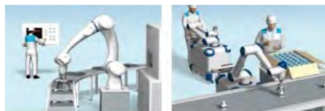
装置内、装置間搬送
