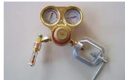
← 写真は、小池酸素工業の逆火防止器 ミニタックルです。吹管の手元にも取り付けて、二重の安心を！
