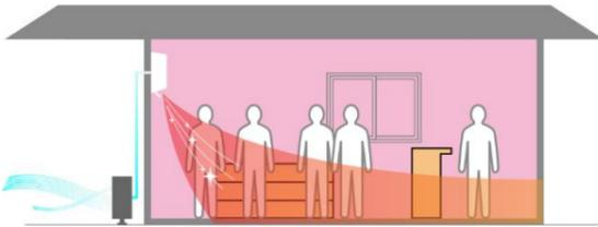
屋外から新鮮な空気を取り込み、エアコンの熱交換器で適温に整えて室内にお届けします。
