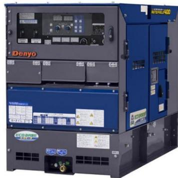
1台多役で幅広く使える炭酸ガスエンジン溶接機。3つのモード(炭酸ガス・手溶接・ガウジング)で400A出力できます。溶接制御はインバータ制御。アークも安定し、ビード端の揃った美しい外観に仕上がります。炭酸ガス/手溶接/ガウジング/三相交流電源/単相交流電源と5つの機能を備えます。新型エンジンモニター搭載により、モード切替はもちろん溶接条件の設定など様々な操作が行えます。交流電源は三相・単相ともに出力できます。
