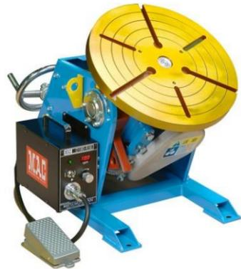
デジタル回転数表示器を搭載。プリセット機能により、容易に適正な回転数の再現が可能。一次側入力AC1Φ100～240Vまで使用可能。独特なフラットカーボンアース集電機構で、減速機がいたまず耐久性にすぐれています。操作は各タイプとも足踏スイッチまたは押しボタンスイッチにて簡単に運転できます。
