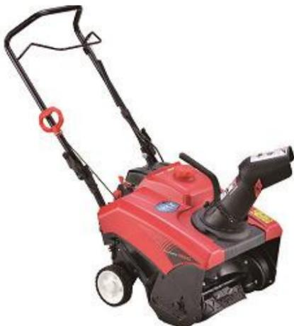
スコップ感覚でお手軽に除雪作業ができます。難しい操作は一切なく、エンジンを始動して除雪レバーを握るだけです。小型、軽量で収納時にハンドルを折りたためてコンパクトに収納できます。オーガーはゴム製ですので路面を傷めません。20cm位までの除雪に最適です。
