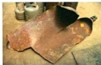
約8年間放置された酸素破裂容器の全景
