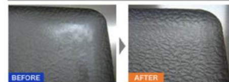
ゴム金型に付着したゴム加硫
