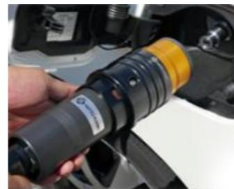
水素ステーションで高圧水素を供給・充填する機器の接続部に使用されています。
